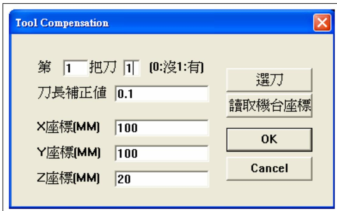
Fig.0m IMPAPTTP 刀長補正位置輸入顯示
